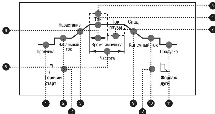
1. **ПРОДУВКА ПЕРЕД СВАРКОЙ:** регулировка времени продувки перед началом сварочного процесса.
